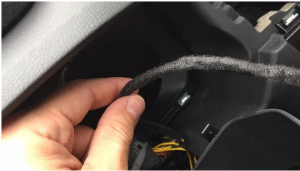
Umwickelte Leitungen zusammengefasst zu einem Strang.
